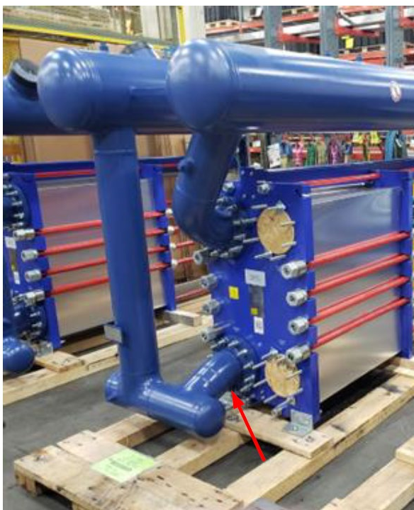
Hình 5. Cửa xả nước trên dàn bay hơi kiểu ngập. Mũi tên màu đỏ chỉ vị trí cửa xả nước [2].
